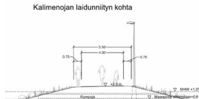
Kuva 39. Kalimenojan läheisyydessä luiskien eroosiosuojaukseen ja maisemaan maastouttamiseen kiinnitetään huomiota. Penkereen helma verhoillaan suurikokoisilla kivillä mikä parantaa eroosiosuojausta eikä houkuttele poistumaan reitiltä.
