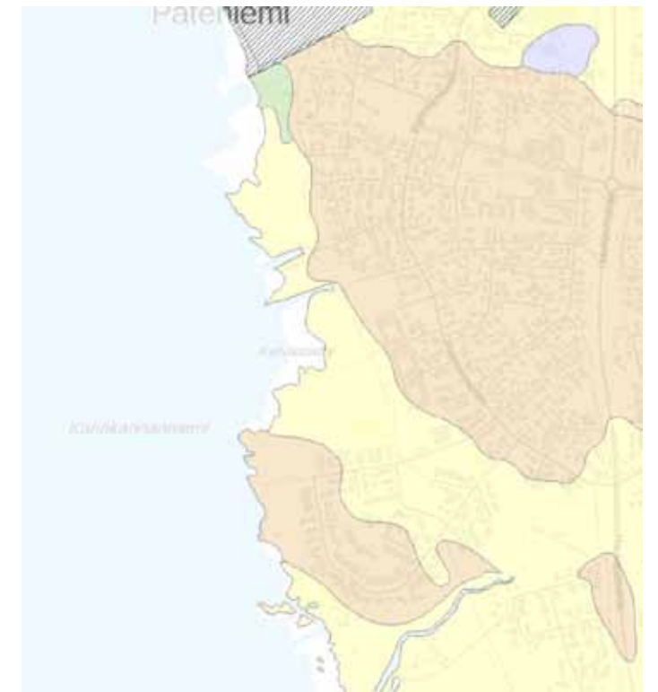
Kuva 20. Ote GTK:n maaperäkartasta Pateniemen alueelta. Keltainen väri on karkeaa hiekkaa (siHK), oranssi hiekkamoreenia, vihreä hiekkaa ja vinoviiva täytemaata.
